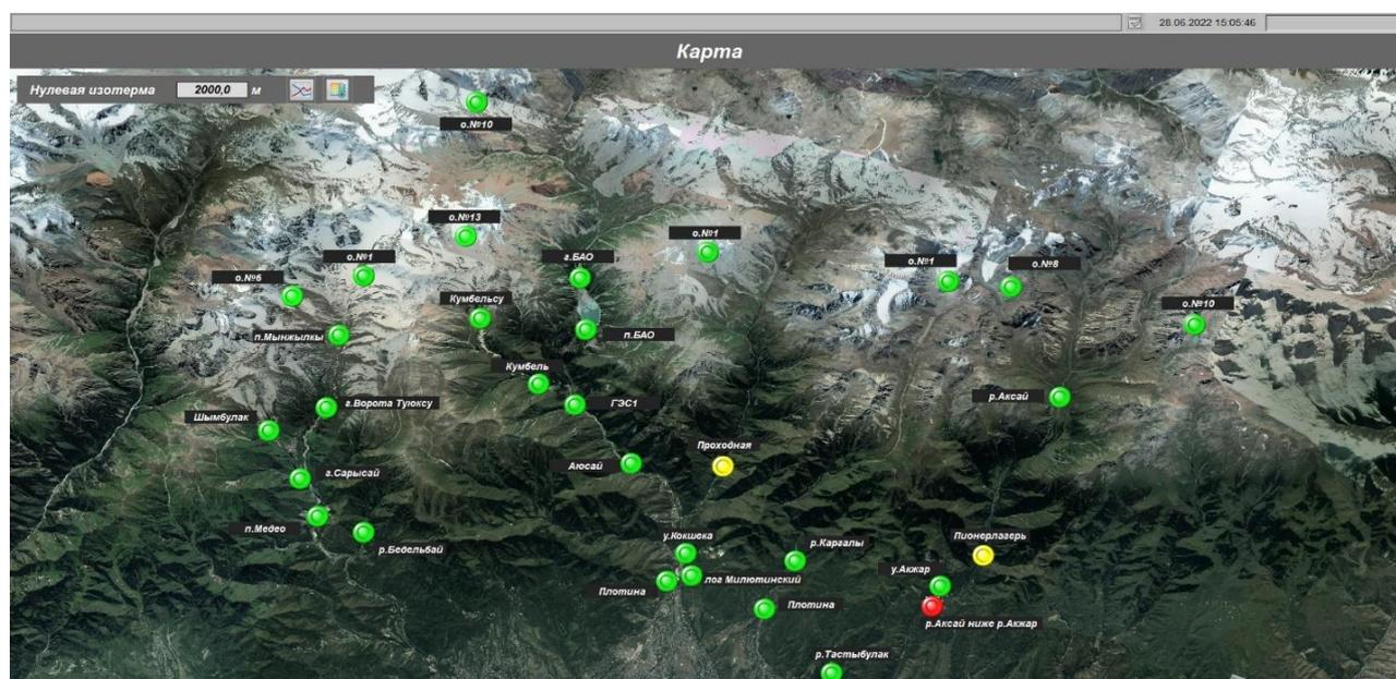
Камеры фото/видеофиксации, установленные на станциях мониторинга позволяют следить за моренными озерами и за реками в онлайн-режиме.
