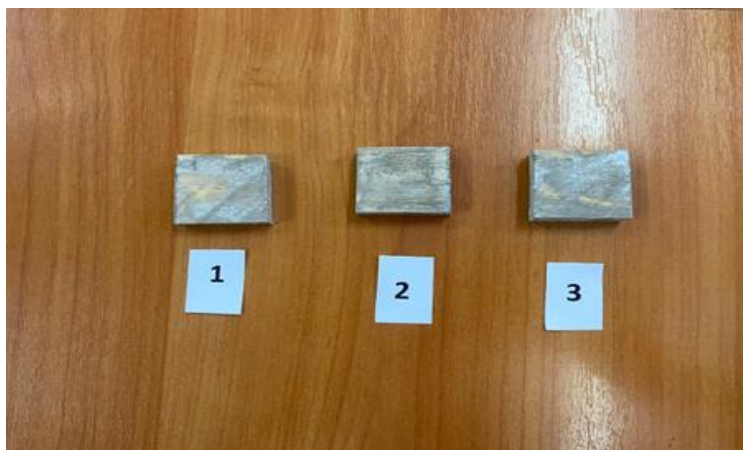
Рисунок 1 - Образцы древесины, обработанные огнезащитным составом
