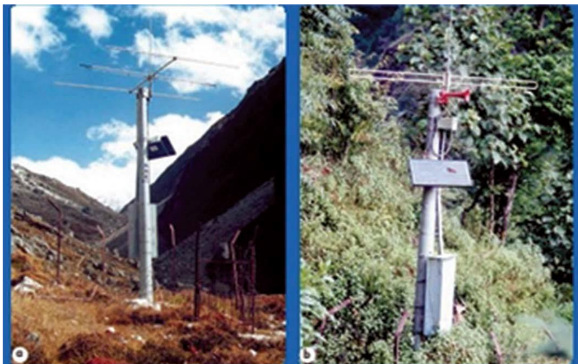
Рисунок 1. Система раннего оповещения о сходе селя в долине Тамакоши: а – станция приема сигнала о прорыве озера; б – станция подачи сигнала предупреждения о сходе селя с сиреной.
