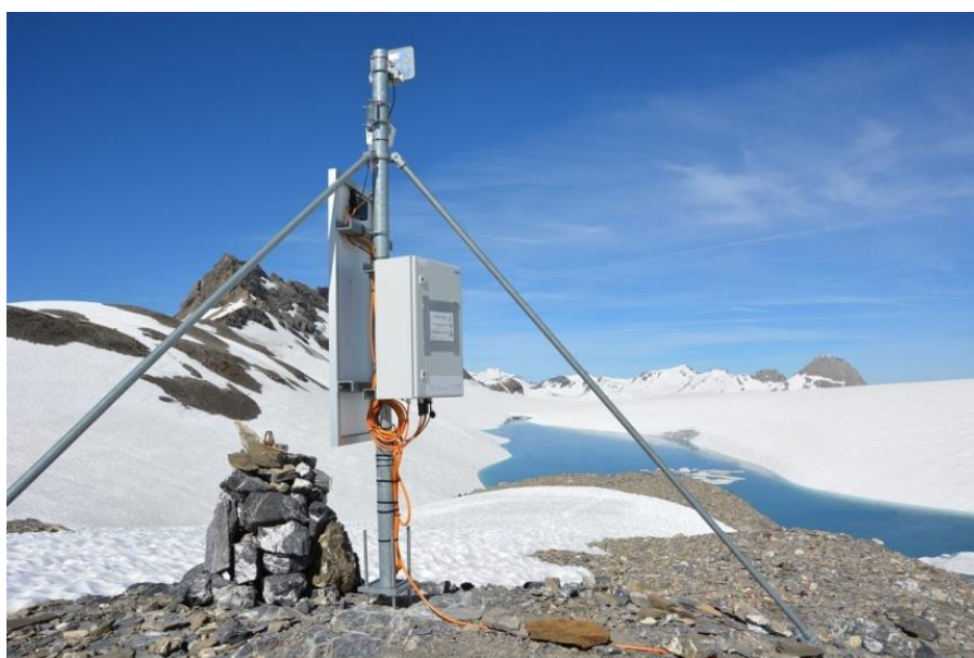
Рисунок 5. Автоматизированный пост наблюдения на ледниковом озере (Бернские Альпы, Швейцария)
