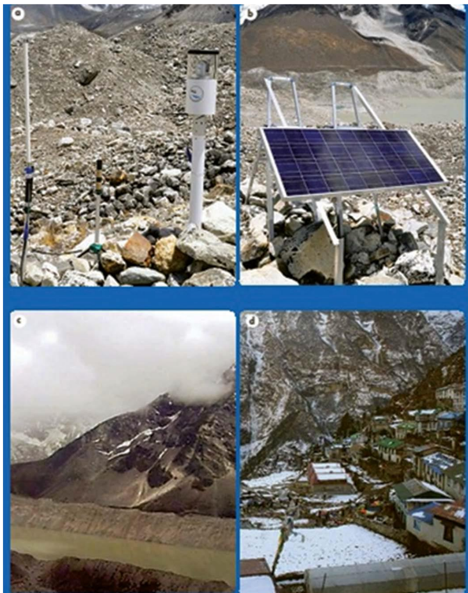
Рисунок 2. Система мониторинга прорывоопасного озера Имджа: а – верхний полевой сервер на озере Имджа; б – солнечная панель полевого сервера; в – вид с верхнего полевого сервера на озеро; д – вид с нижнего полевого сервера на поселок Намче Базар.
