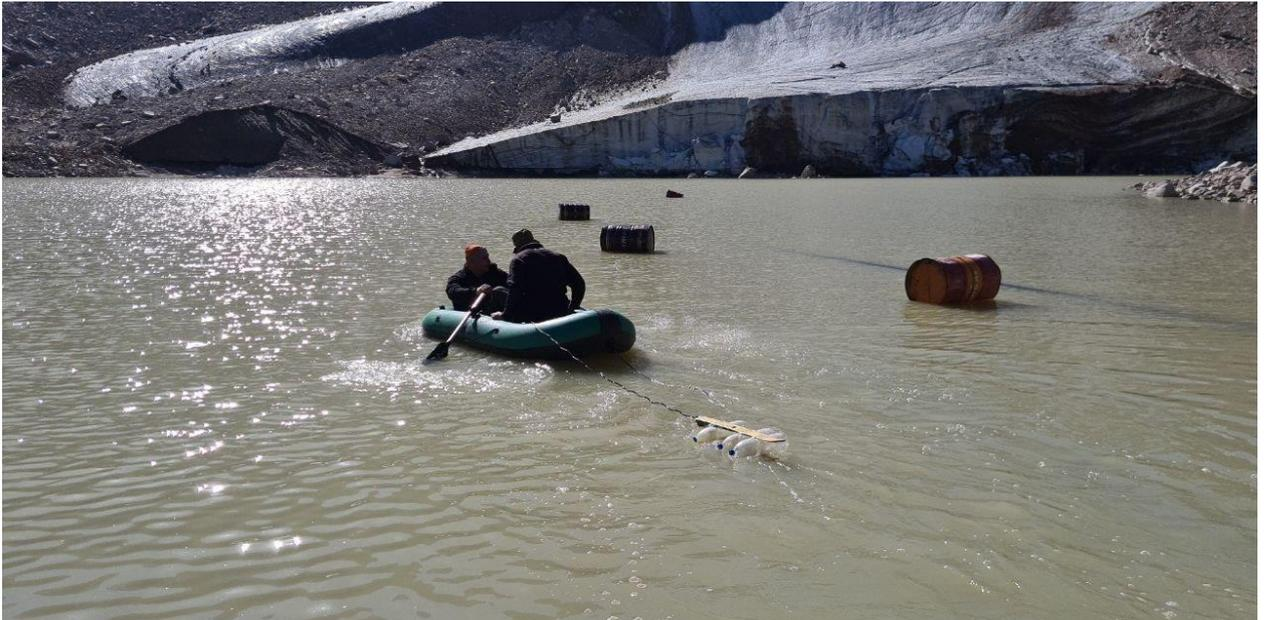
*Снимок 45. Батиметрическое обследование озера 13-бис*
