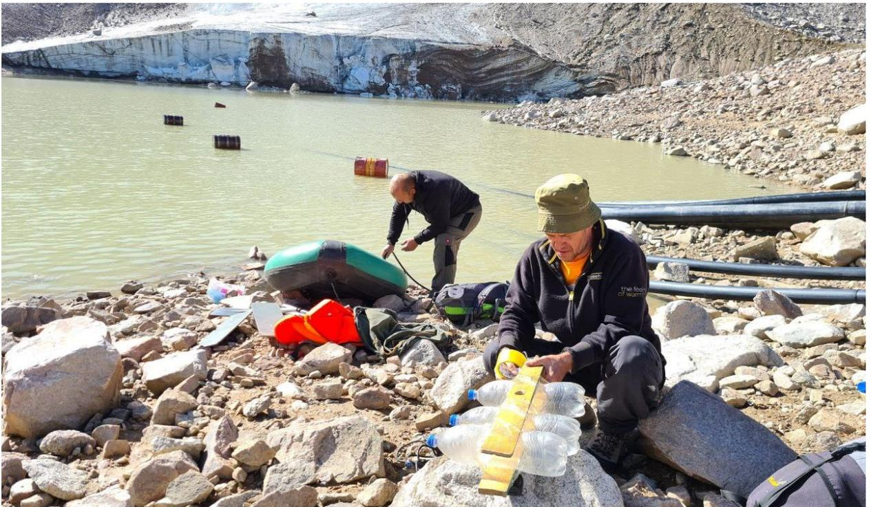
Снимок 44. Подготовка плавсредства, эхолота и GPS треккера к батиметрическим исследованиям
