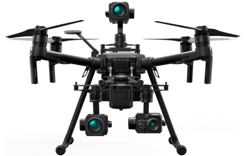
3. Желательно не взлетать с песка так как можно погубить двигатели и подвес камеры. Взлет и посадка только с твердой поверхности.
